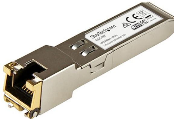
El modelo 10050-ST es un módulo transceptor SFP por cobre compatible con el modelo 10050 de Extreme Networks diseñado, programado y probado para su funcionamiento con routers y switches de la marca Extreme Networks®. Ofrece conectividad fiable a 1 GbE, a través de cable de cobre, para redes compatibles con 10/100/1000BASE-TX, a una distancia máxima de hasta 100 m.
