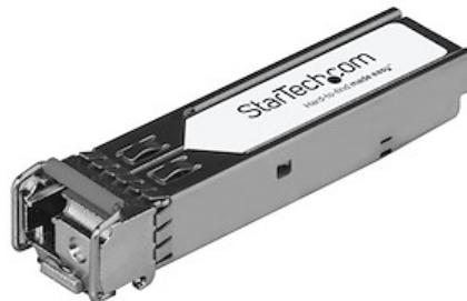
Le 10057-ST est un transceiver SFP fibre optique en amont compatible Extreme Networks 10057 qui fonctionne avec 10056H-ST de StarTech.com. Ils sont conçus, programmés et testés pour fonctionner avec des commutateurs et des routeurs compatibles avec les normes MSA 1000BASE-BX. Le module de transceiver SFP+ fonctionne jusqu'à une distance de 10 km et vous assure une connectivité de 1 GbE par câblage optique.
