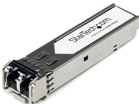
El modelo 10302-ST es un módulo transceptor SFP+ por fibra óptica compatible con el modelo 10302 de Extreme Networks diseñado, programado y probado para su funcionamiento con routers y switches de la marca Extreme Networks®. Ofrece conectividad fiable a 10 GbE, a través de cable de fibra óptica, para redes compatibles con 10GBASE-LR, a una distancia máxima de hasta 10 km.
