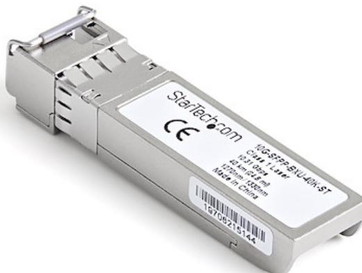
Der 10G-SFPP-BXU-40K-ST ist ein MSA-konformer Upstream Glasfaser SFP+-Transceiver, der mit 10G-SFPP-BXD-40K von StarTech.com verbunden werden kann. Er wurde für den Einsatz mit 10GBASE-BX-kompatiblen MSA-Switches und -Routern entwickelt. Das SFP+-Transceiver-Modul unterstützt eine maximale Entfernung von bis zu 40 km und sorgt für zuverlässige 10 GbE-Konnektivität via Glasfaser-Verkabelung.
