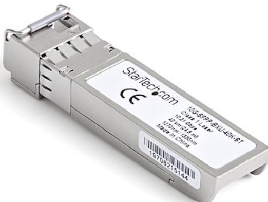
Il 10G-SFPP-BXU-40K-ST è un ricetrasmettitore SFP+ a monte in fibra compatibile con Brocade 10G-SFPP-BXU-40K associabile con 10G-SFPP-BXD-40K di StarTech.com. Sono progettati, programmati e testati per funzionare con switch e router compatibili MSA 10GBASE-BX. Il modulo ricetrasmettitore SFP+ supporta una distanza massima di fino a 40 km e offre una connettività affidabile 10 GbE usando cavi in fibra.
