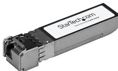
Der 10G-SFPP-BXU-ST ist ein MSA-konformer Upstream Glasfaser SFP+-Transceiver, der mit 10G-SFPP-BXD von StarTech.com verbunden werden kann. Er wurde für den Einsatz mit 10GBASE-BX-kompatiblen MSA-Switches und -Routern entwickelt. Das SFP+-Transceiver-Modul unterstützt eine maximale Entfernung von bis zu 20 km und sorgt für zuverlässige 10 GbE-Konnektivität via Glasfaser-Verkabelung.
