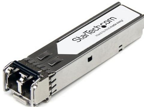
Der 10G-SFPP-LR-ST ist ein Brocade 10G-SFPP-LRM-kompatibles Glasfaser SFP+-Transceiver-Modul, das für den Einsatz mit Brocade® Marken-Switches und -Routern entwickelt, programmiert und getestet wurde. Es sorgt für zuverlässige 10 GbE-Konnektivität über Glasfaser-Kabel für 10GBASE-LRM-konforme Netzwerke mit einer maximalen Entfernung von bis zu 200m.
