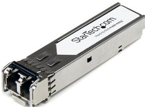
El modelo 10G-SFPP-LR-ST es un módulo transceptor SFP+ por fibra óptica compatible con el modelo 10G-SFPP-LRM de Brocade diseñado, programado y probado para su funcionamiento con routers y switches de la marca Brocade®. Ofrece conectividad fiable a 10 GbE, a través de cable de fibra óptica, para redes compatibles con 10GBASE-LRM, a una distancia máxima de hasta 200 m.
