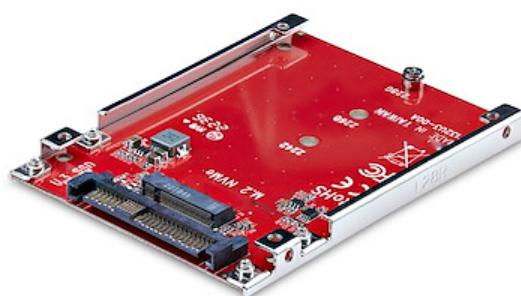
Convertissez et connectez un SSD PCIe M.2 NVMe/AHCI à un facteur de forme de 2,5 pouces pour l'installer dans une baie de lecteur U.3 ou un fond de panier.
