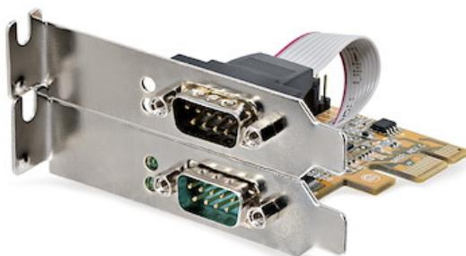
Añada soporte de comunicación en serie a su sistema de factor de forma pequeño (SFF) o sistema de tamaño completo, utilizando esta tarjeta de dos puertos en serie. La compatibilidad con RS-232 (DB9) permite el control y la comunicación con un dispositivo periférico serie.
