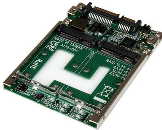
Permite aumentar considerablemente el rendimiento del sistema al agregar una matriz de doble mSATA SSD RAID en cualquier aplicación de disco duro SATA HDD de 2,5", mediante el adaptador mSATA a SATA, modelo 25SAT22MSAT.
