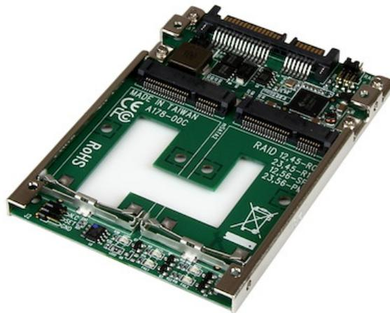
L'adattatore mSATA a SATA 25SAT22MSAT incrementa notevolmente le prestazioni del sistema aggiungendo un array RAID doppio SSD mSATA in qualsiasi applicazione per HDD SATA 2,5".
