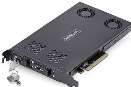
Utilice una ranura de expansión PCIe x8 disponible para instalar, extraer o intercambiar unidades SSD M.2 PCIe. Admite unidades SSD M.2 NVMe M-Key 2230, 2242, 2260 y 2280 con velocidades de lectura/escritura de alto rendimiento de hasta 64 Gbps por Unidad.
