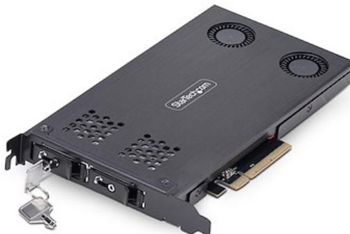
Utilizza uno slot di espansione PCIe x8 disponibile per installare, rimuovere o scambiare le unità SSD PCIe M.2. Supporta le unità SSD M.2 NVMe 2230, 2242, 2260 e 2280 M-Key con velocità di lettura/scrittura ad alte prestazioni fino a 64 Gbps per unità.
