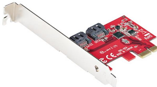
Este controlador SATA III de 2 puertos (6Gbps) le permite añadir dos discos duros (HDD) SATA de 6Gbps o unidades de estado sólido (SSD) a su sistema informático o servidor a través de una ranura de tarjeta PCIe x1 disponible. La tarjeta es compatible con las especificaciones SATA III y PCI-Express 2.0.
