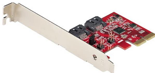
Questo controller SATA III (6Gbps) con 2 porte RAID ti consente di aggiungere due dischi rigidi (HDD) SATA 6Gbps o unità a stato solido (SSD) ad un sistema informatico o server esistente tramite uno slot per scheda PCIe x2 disponibile, e realizzare una soluzione RAID hardware. La scheda supporta le specifiche SATA III e PCI-Express 2.0, e può anche essere usata per aggiungere unità disco ottiche (ODD) come CD/DVD/Blu-ray al computer.
