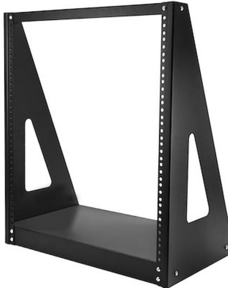
Ce rack à deux montants se pose au sol ou sur votre bureau pour fournir 12U d'espace de stockage pour les appareils 19" montables en rack, conformes à la norme EIA-310-D, tels que les équipements de télécommunication et audio/vidéo. Le rack constitue une solide solution de stockage qui prend en charge une capacité de charge totale de 160 kg.
