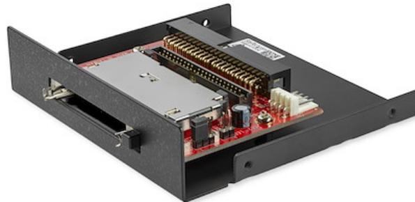
Este adaptador IDE a Compact Flash es la solución perfecta para acceder a tarjetas CompactFlash (CF I, CF II) y Micro Discos Duros IBM (Micro Drive), permitiéndole acceder a sus unidades de memoria flash o micro drive como si fueran un disco duro IDE.
