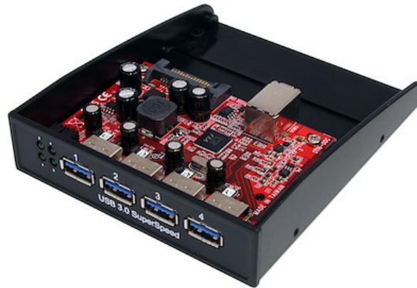
Le concentrateur de panneau avant 35BAYUSB3S4 baie en façade USB 3.2 Gen 1 de 3,5 po vers 4 ports transforme n'importe quelle baie avant de 3,5 po en concentrateur USB 3.2 Gen 1 à 4 ports.
