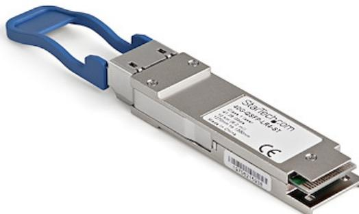
Le 40G-QSFP-LR4-ST est un module de transceiver QSFP fibre optique compatible Brocade 40G-QSFP-SR4 qui a été conçu, programmé et testé pour fonctionner avec des commutateurs et des routeurs de marque Brocade®. Il vous assure une connectivité de 40 GbE par câble en fibre optique, sur les réseaux compatibles 40GBASE-SR4 et sur une distance maximale de 150 m.
