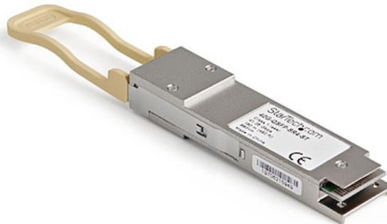
El modelo 40G-QSFP-SR4-ST es un módulo transceptor QSFP por fibra óptica compatible con el modelo 40GBASE-LR4 de Brocade diseñado, programado y probado para su funcionamiento con routers y switches de la marca Brocade®. Ofrece conectividad fiable a 40 GbE, a través de cable de fibra óptica, para redes compatibles con 40GBASE-LR4, a una distancia máxima de hasta 10 km.
