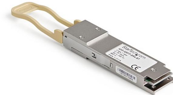
Il 40G-QSFP-SR4-ST è un modulo ricetrasmittitore QSFP in fibra compatibile con Brocade 40GBASE-LR4 progettato, programmato e testato per funzionare con switch e router prodotti da Brocade®. Offre una connettività affidabile 40 GbE su cavo in fibra per le reti compatibili con 40GBASE-LR4 a una distanza massima di 10 km.
