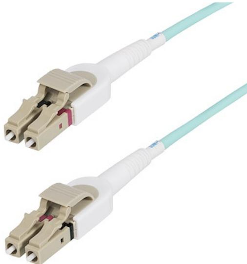
Le câble à fibre optique multimode commutable LC/UPC vers LC/UPC OM4 permet des connexions réseau 40/100G. Les boîtiers de protection rétractables permettent un changement de polarité sur site sans outils. Les connecteurs LC-Duplex codés par couleur assurent une configuration de polarité sans erreur.
