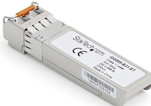
Le 455889-B21-ST est un module de transceiver SFP+ fibre optique compatible HPE 455889-B21 qui a été conçu, programmé et testé pour fonctionner avec des commutateurs et des routeurs de marque HPE®. Il vous assure une connectivité de 10 GbE par câble en fibre optique, sur les réseaux compatibles 10GBASE-LRM et sur une distance maximale de 200 m.
