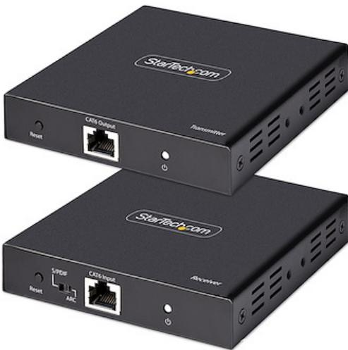
Ce prolongateur HDMI® transmet un signal audio vidéo HDMI 4K 60Hz jusqu'à 70 m sur un câblage Ethernet de catégorie 5e/6. Le kit de conversion comprend les unités d'émission et de réception pour une solution complète de point à point.
