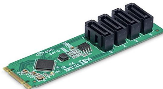
Fügen Sie einem Desktop bis zu vier unabhängige SATA-Laufwerke über einen einzigen 2280 M.2-Laufwerkssteckplatz hinzu, wobei die SATA-Lese-/Schreibgeschwindigkeiten von 6 Gbit/s pro Laufwerk beibehalten werden.
