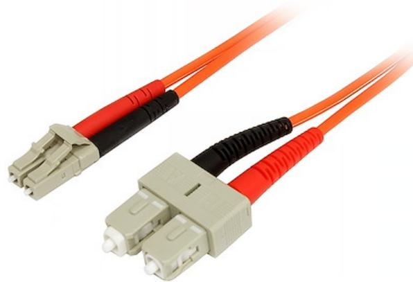
El cable de fibra óptica (3 m), categoría LSZH, LC a SC, modelo 50FIBLCSC3, con fibra óptica de 50/125 micrones para alta velocidad, proporciona transmisiones de datos a alto ancho de banda a través de redes Gigabit Ethernet y canal de fibra, con soporte para aplicaciones dúplex multimodo.
