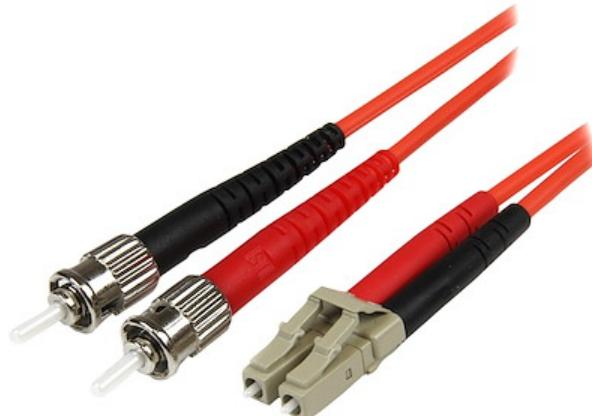
Le câble à fibre optique LC vers ST LSZH 1 m 50FIBLCST1 comprend une fibre de 50/125 microns pour la transmission de données haute vitesse, à large bande passante sur des réseaux Gigabit Ethernet et Fiber Channel, avec la prise en charge d'applications duplex multimodes.
