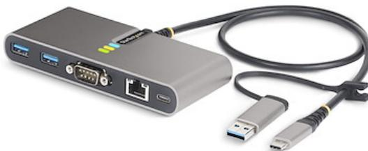
Dieser USB Typ-C Hub mit serieller RS-232 Schnittstelle, Gigabit Ethernet und 100W USB-C Power Delivery Pass-Through fügt einem USB-fähigen Computer zwei USB 3.2 Gen 1 (5Gbps) Typ-A Anschlüsse hinzu. Das beiliegende 60 cm lange USB-C-Hostkabel enthält einen USB-C-zu-USB-A-Adapter, mit dem der USB-Hub sowohl an USB-A- als auch an USB-C-Hostcomputer angeschlossen werden kann.
