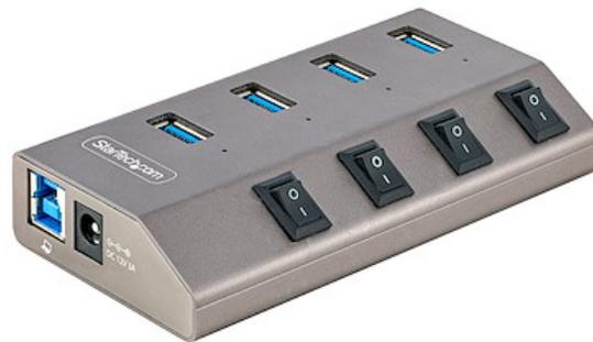
Este hub USB 3.2 Gen 1 (5Gbps) de 4 puertos añade cuatro puertos USB Tipo-A a un ordenador, con la ventaja añadida de que cada puerto tiene un interruptor individual de encendido/apagado. El hub USB se autoalimenta con un adaptador de corriente incluido. Se conecta a un puerto USB-A, o USB-C de un ordenador portátil o de sobremesa.
