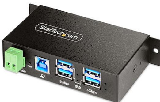
Questo hub USB 3.2 Gen 1 (5Gbps) industriale gestito a 4 porte consente agli utenti di attivare/disattivare le singole porte USB e di riavviare l'hub, utilizzando il software USB Hub Administrator (scaricabile gratuitamente). Con un alloggiamento robusto e opzioni di ingresso di alimentazione versatili, l'hub USB è progettato per soddisfare le esigenze dei professionisti IT che lavorano in ambienti industriali come fabbriche, magazzini, uffici e ambienti simili.
