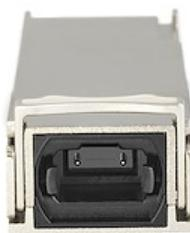
El modelo 747698-B21-ST es un módulo transceptor QSFP por fibra óptica compatible con el modelo 747698-B21 de HPE diseñado, programado y probado para su funcionamiento con routers y switches de la marca HPE®. Ofrece conectividad fiable a 40 GbE, a través de cable de fibra óptica, para redes compatibles con 40GBASE-SR4, a una distancia máxima de hasta 400 m.
