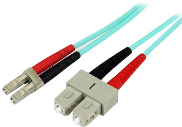
Perfecto para tendidos de cable de fibra entre múltiples conmutadores, concentradores y enrutadores, así como equipos de red de gama alta, este cable de fibra dúplex multimodo 10 Gigabits de alta velocidad está terminado con un conector LC en un extremo y un conector SC en el otro, y está compuesto por fibra aqua OM3 de 50/125 micras para ofrecer transferencias de datos fiables a velocidades de vértigo.
