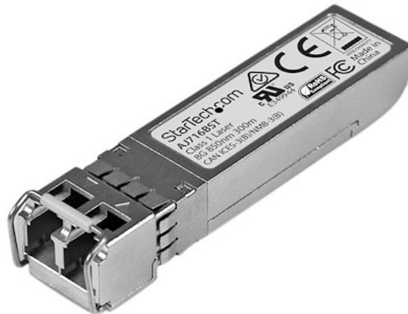
El modelo AJ716BST es un módulo transceptor por fibra óptica, compatible con el modelo AJ716B de HPE, diseñado, programado y probado para su funcionamiento con enrutadores y conmutadores de la marca HPE®. Ofrece conectividad 8GbE fiable a través de cable de fibra óptica para redes compatibles con 8GFC, con una distancia máxima de hasta 300m.
