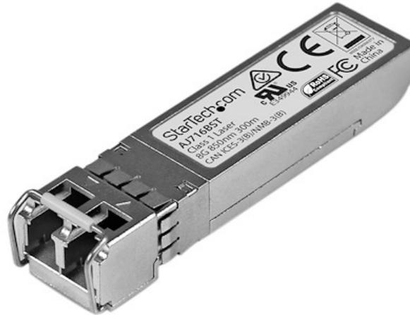
Le modèle AJ716BST est un module de transceiver à fibre optique compatible avec HPE AJ716B, qui a été conçu, programmé et testé pour fonctionner avec les commutateurs et routeurs de la marque HPE®. Il fournit une connectivité 8 Gb fiable sur câble à fibre optique pour les réseaux conformes aux spécifications 8GFC, avec une distance maximale de 300 m.
