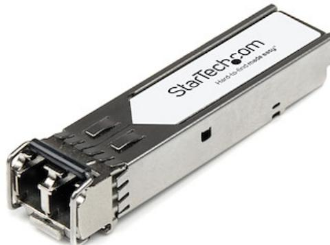
AR-SFP-1G-SX-STは、Arista Networks製SFP-1G-SX互換のSFPトランシーバモジュールです。Arista Networks®ブランドのスイッチ／ルーターでの使用を想定した設計・プログラミング・テストが行われています。光ファイバケーブルで、1000 BASE-SX準拠1GbEネットワークの安定した接続機能を提供します。最大で550mの距離に対応します。
