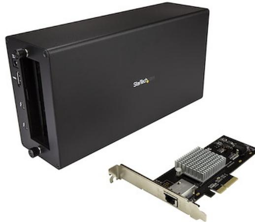
Esta tarjeta NIC Thunderbolt™ 3 a 10GbE le permite conectar su dispositivo habilitado para Thunderbolt 3 a una red de 10GbE. Este adaptador combina el chasis de expansión Startech.com Thunderbolt 3 PCIe (TB31PCIEX16) y la tarjeta NIC PCI Express 10G (ST10000SPEXI), los cuales le ofrecen una salida DisplayPort, un puerto Thunderbolt 3 adicional y un puerto RJ45 (10GbE).
