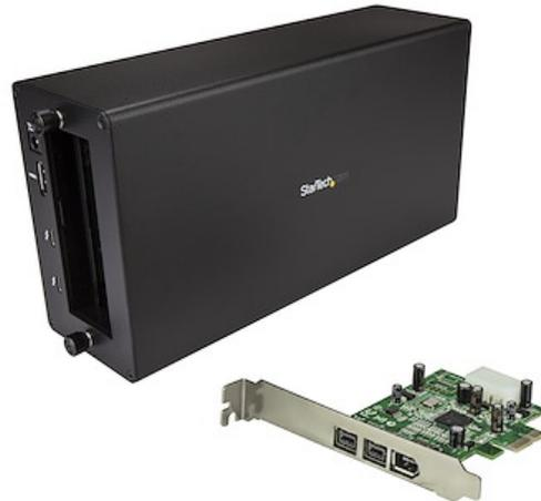
El adaptador Thunderbolt 3 a FireWire 1394 conecta sus periféricos FireWire a su ordenador con Thunderbolt 3. Este adaptador combina el chasis de expansión PCIe Thunderbolt 3 de StarTech.com (TB31PCIEX16) con la tarjeta adaptadora FireWire 1394 (PEX1394B3). El chasis usa la tecnología Thunderbolt 3, la conexión más rápida disponible, compatible con sus dispositivos FireWire®, además de una salida DisplayPort y un puerto Thunderbolt 3 adicional.
