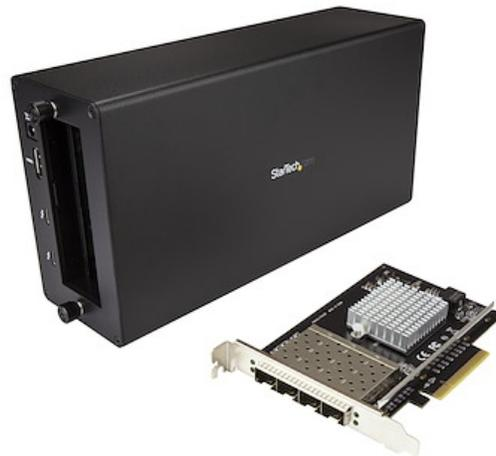
Cet adaptateur Thunderbolt™ 3 vers carte réseau 10GbE vous permet de connecter un appareil Thunderbolt 3 à un réseau 10GbE. L'adaptateur combine la technologie Thunderbolt 3 du modèle TB31PCIEX16 et la connexion à double fibre optique 10GbE du modèle PEX10GSFP4I (chipset Intel® XL710). L'adaptateur assemblé est équipé d'une sortie DisplayPort, d'un port Thunderbolt 3 supplémentaire et de quatre slots SFP+ 10GbE ouverts.
