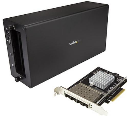
Este adaptador Thunderbolt™ 3 a NIC 10GbE le permite conectar un dispositivo Thunderbolt 3 a una red de 10GbE. El adaptador combina la tecnología Thunderbolt 3 de TB31PCIEX16 con la conexión de fibra dual 10GbE de PEX10GSFP4I (chipset Intel® XL710). El adaptador ensamblado presenta una salida DisplayPort, un puerto Thunderbolt 3 adicional y cuatro ranuras SFP+ abiertas de 10GbE.
