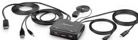
Dieser Hybrid KVM-Switch ermöglicht Benutzern, zwischen einem USB Typ-A und DisplayPort-fähigen Desktop und einem USB Typ-C (DP Alt-Modus) Laptop zu wechseln, um Tastatur, Maus, Audio Eingabe-/Ausgabegeräte und einen einzelnen 4K 60Hz DisplayPort Monitor zu teilen.
