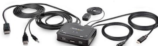
Este conmutador KVM híbrido permite a los usuarios alternar entre un ordenador de sobremesa habilitado para USB tipo A y DisplayPort y un ordenador portátil habilitado para USB tipo C (DP Alt-Mode), para compartir un teclado, un ratón, dispositivos de entrada/salida de audio y un único monitor DisplayPort 4K 60Hz.
