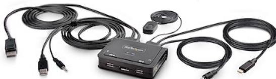
Ce commutateur KVM hybride permet aux utilisateurs de basculer entre un ordinateur de bureau compatible USB Type-A et DisplayPort et un ordinateur portable compatible USB Type-C (DP Alt-Mode), pour partager un clavier, une souris, des périphériques d'entrée/sortie audio et un seul moniteur DisplayPort 4K 60Hz.
