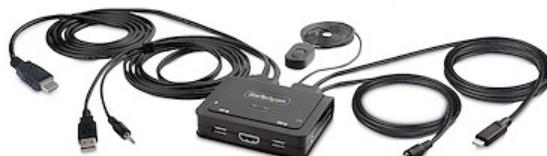
Dieser Hybrid KVM-Switch ermöglicht Benutzern, zwischen einem USB Typ-A und HDMI-fähigen Desktop und einem USB Typ-C (DP Alt-Modus) Laptop zu wechseln, um Tastatur, Maus, Audio Eingabe-/Ausgabegeräte und einen einzelnen 4K 60Hz HDMI Monitor zu teilen.
