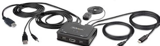
Ce commutateur KVM hybride permet aux utilisateurs de basculer entre un ordinateur de bureau compatible USB Type-A et HDMI et un ordinateur portable compatible USB Type-C (DP Alt-Mode), afin de partager un clavier, une souris, des périphériques d'entrée/sortie audio et un seul moniteur HDMI 4K 60Hz.
