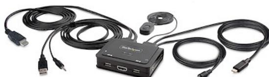
Questo switch KVM ibrido consente agli utenti di passare da un desktop dotato di USB Tipo-A e HDMI a un laptop dotato di USB Tipo-C (che supporta la modalità DP Alt), per condividere una tastiera, un mouse, dispositivi di ingresso/uscita audio e un singolo monitor HDMI 4K 60Hz.
