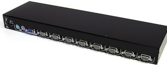
Questo modulo KVM a 8 porte funziona con la serie StarTech.com di console LCD montate a rack, permettendo di controllare otto server da un'unica postazione. È possibile eseguire l'upgrade di una console LCD a porta singola, oppure sostituire una console difettosa (vedere il nostro elenco di console LCD compatibili di seguito).
