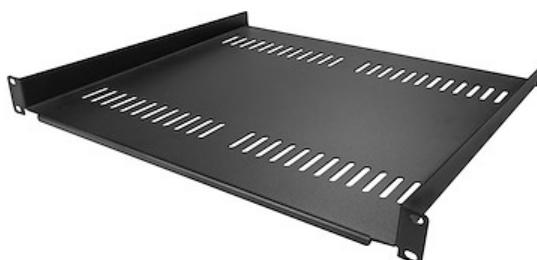
Este paquete de 2 estantes para rack 1U añade almacenamiento de perfil bajo a cualquier rack o armario para servidores de 19 pulgadas que cumpla la norma EIA-310. El estante está ventilado para mejorar el flujo de aire a los equipos de misión crítica. Se incluyen tuercas jaula, tornillos y arandelas para su instalación.
