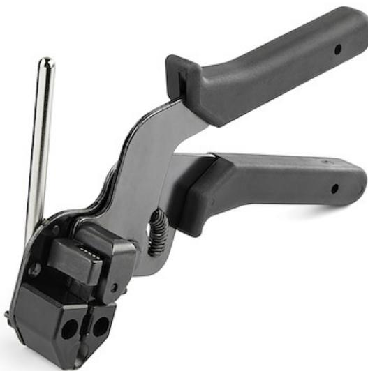
Cette pince serre-câbles, installe rapidement et facilement les attaches de câbles métalliques. Un accessoire idéal pour les attache câble en acier inoxydable 316SS de StarTech.com - Lot de 50 (CBMMCT) vendues séparément.
