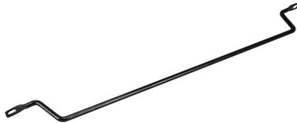
Queste barre di allacciamento si installano orizzontalmente sulla parte anteriore o posteriore del rack per fornire un punto di fissaggio sicuro per gestire i cavi; questi vanno fissati alle barre di allacciamento con fascette per cavi per ridurre la tensione su di essi e impedire di danneggiare le porte sull'apparecchiatura con montaggio a rack. Le barre di allacciamento presentano un distanziale di 5 cm per un comodo accesso ai cavi.
